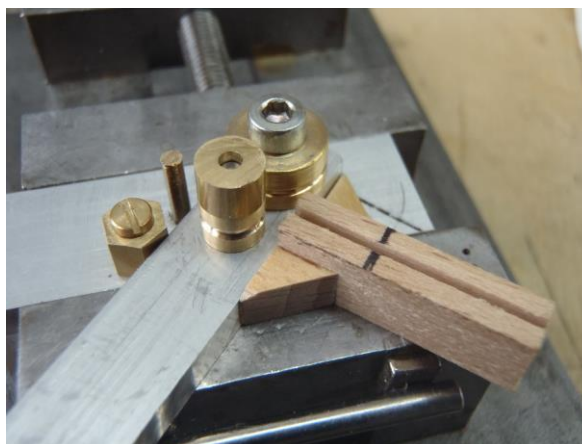
Rohrbiegevorrchtung für die Peitschenleuchten, BILD HOS
