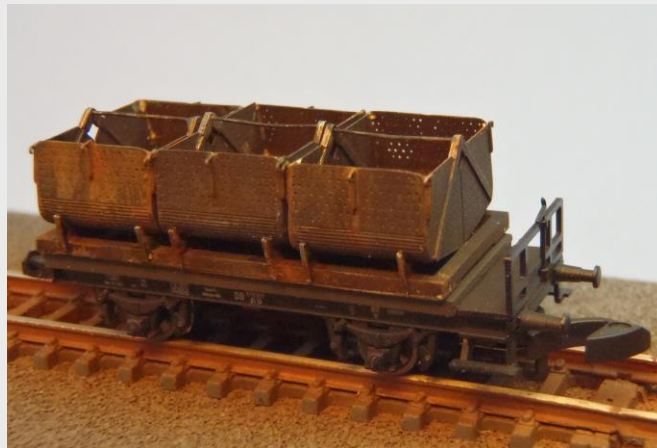
Zweiachsiger Kleinkübelwagen mit drei Klappkübeln" für Briketts. Ladegewicht 20 to, Inhalt der Kübel je 8,2 Kubikmeter Gewicht je Kübel 1,55 to
