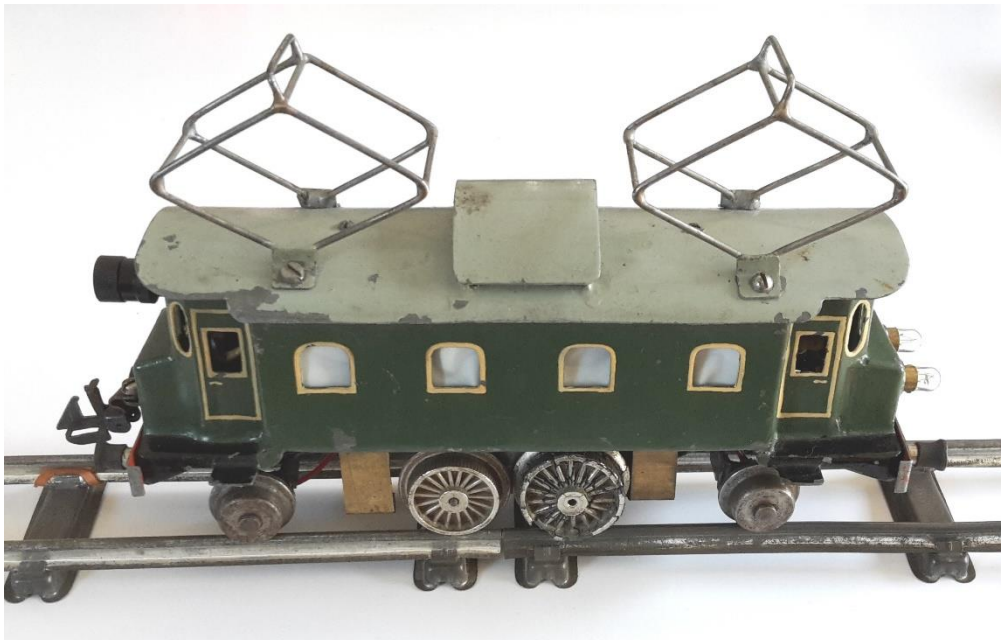
Die Lok vor der Restaurierung – Zinkfraß und diverse Lackschäden
